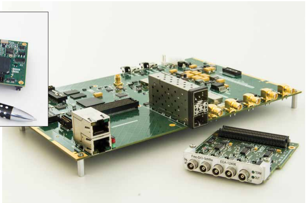
图3 — “大白兔” LEN电路板（上图）和ZEN（右图）电路板。它们分别由 Artix FPGA和Zynq SoC器件提出支持，采用支持工业应用的适当外壳。
