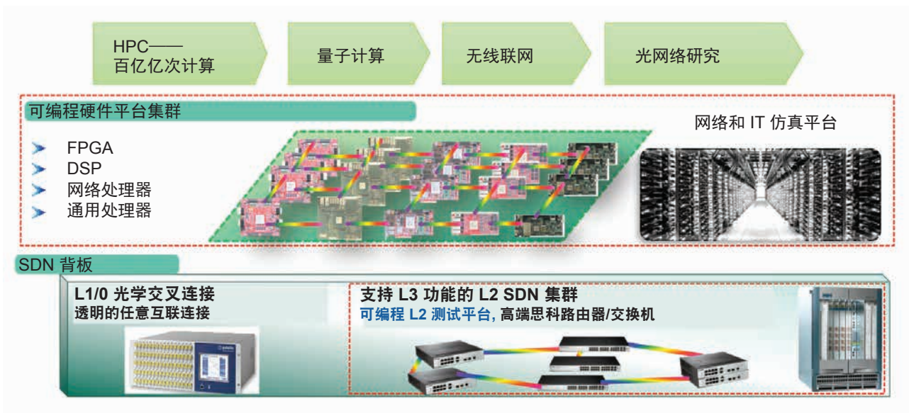
图 4 – Bristol Is Open 中的仿真设施包括以 FPGA 和网络处理器为主要形式的可编程硬件。
