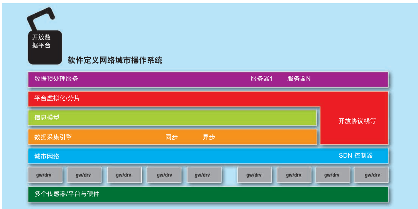
图 2 – NetoOS 是一个基于 SDN 的平台，构建于多层结构之中，可与网络、IT 和物联网技术进行通信。该平台原生支持数据收集、虚拟化、信息建模并可连接第三方应用。
