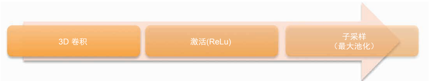
图 2 – AlexNet 中的卷积层执行 3D 卷积、激活和子采样。
