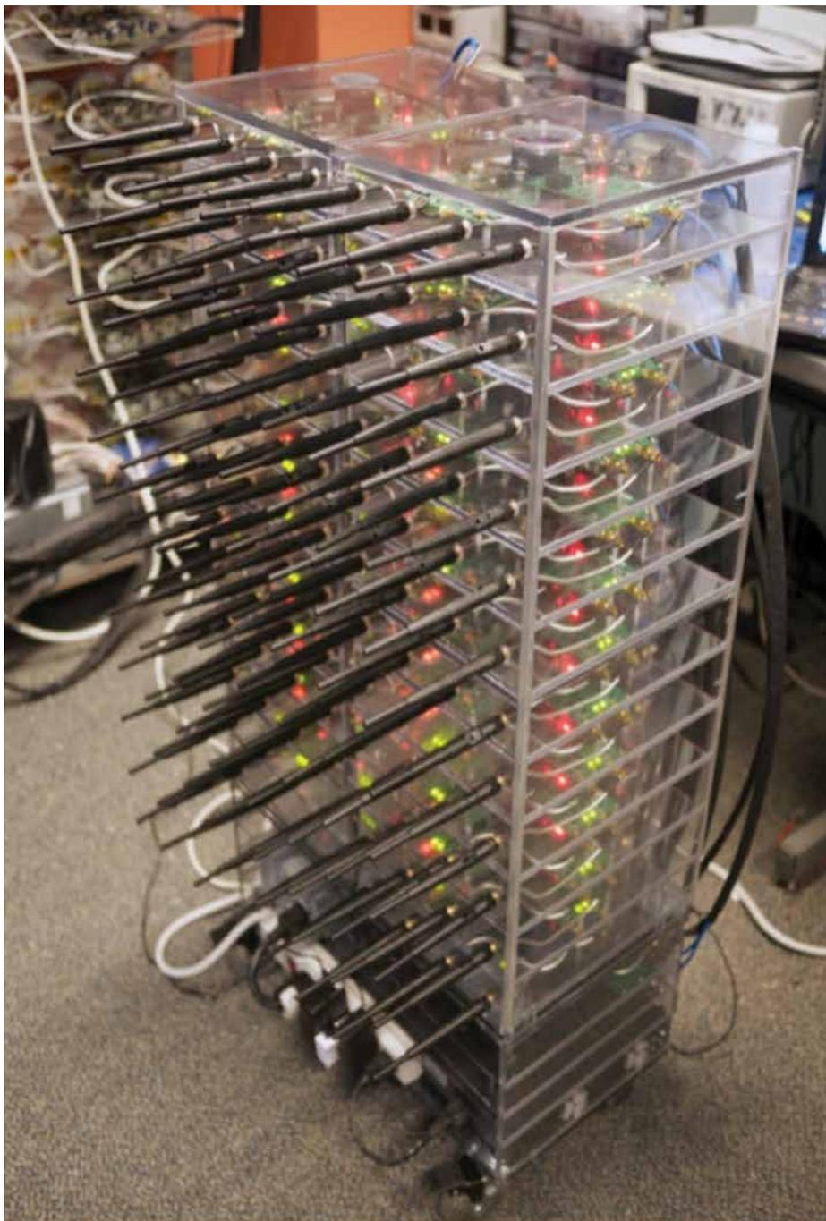
图2 – 莱斯大学Argos v2阵列包含24个四无线电WARP v3节点，具备共享时钟和以太网连接。
