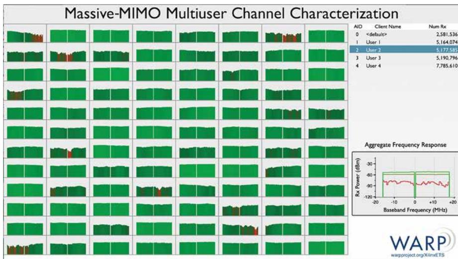
图5—定制MU-MIMO信道分析应用中的信道数量视图。每个条形图代表每天线每副载波的信道数量
