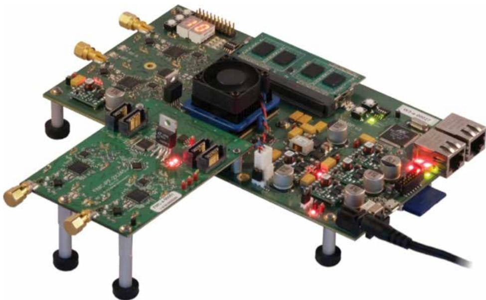
图1 – 具有双无线电FMC模块的WARP v3硬件可提供一个FPGA、四个RF接口、存储器和两个以太网连接。
