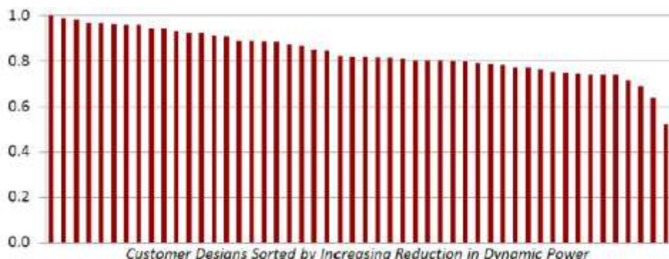
图3：运用智能时钟门控优化实现的动态功耗比率（按动态功耗降幅分类）
