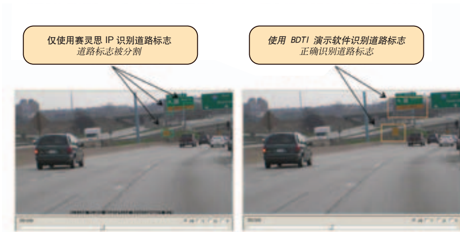
图 2 - 采用专门针对应用定制的二级算法进一步处理 FPGA 的视频分析硬件电路输出的元数据
