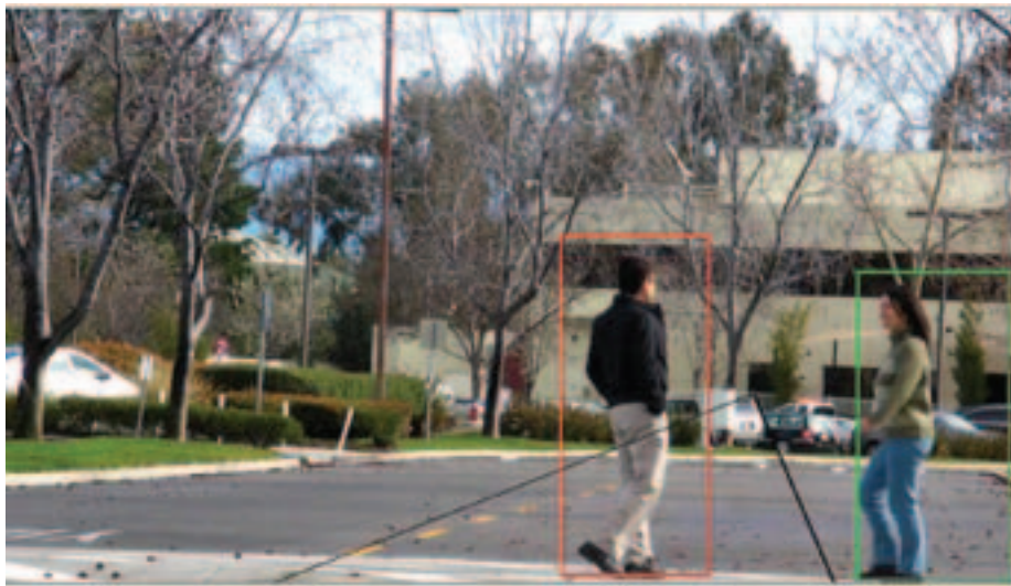
图3: 在行人检测和跟踪功能中包括一项“绊网”警报功能, 当行人进入视频帧的有界部分的时候就会发出警报
