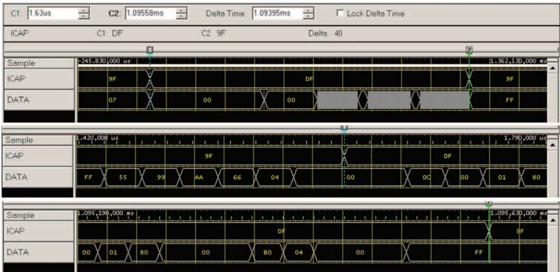
图 3 - 六个 Slice 组成的配置帧区域的 ICAP 时序
