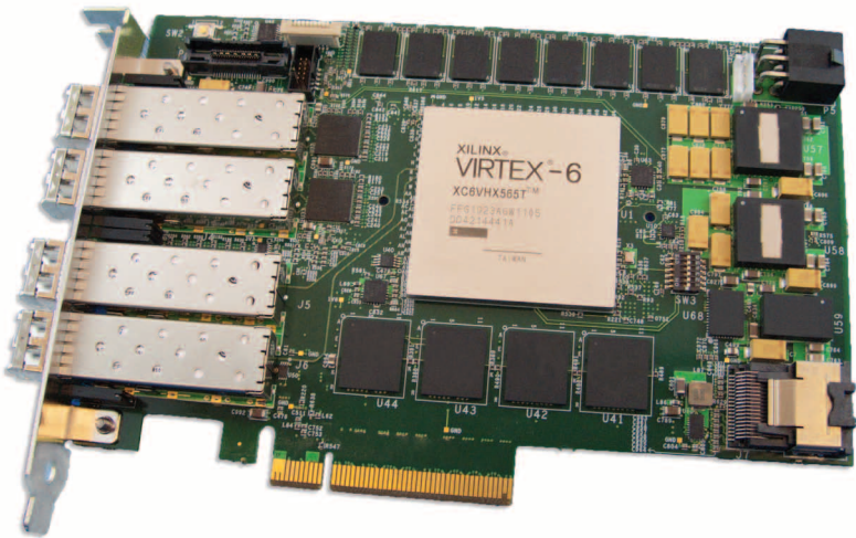
图 6 - V5022 是一个在金融交易系统中广泛部署的单插槽半长卡
