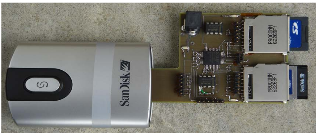
图 7: 插在 USB SD 卡读卡器中的演示板
