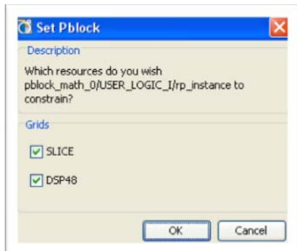
図 21 : [SLICE] と [DSP48] をオンにした [Set Pblock] ダイアログ ボックス
